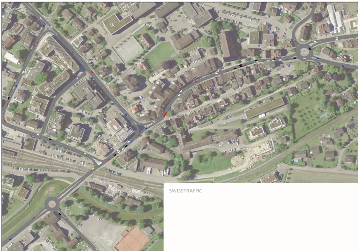
Abbildung 14: Bildausschnitt aus dem Modell mit umgesetzter Massnahme 3 (Verkehrsführung + zusätzliche Kreisel) von Uznach: Leichter Rückstau vor Kreisel Ricken- / Gasterstrasse bis zurück ins Städtli
